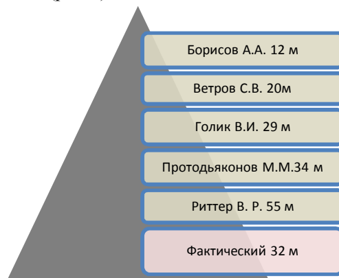
Рис.5. Расчетный и фактический пролет обнажения пород кровли
