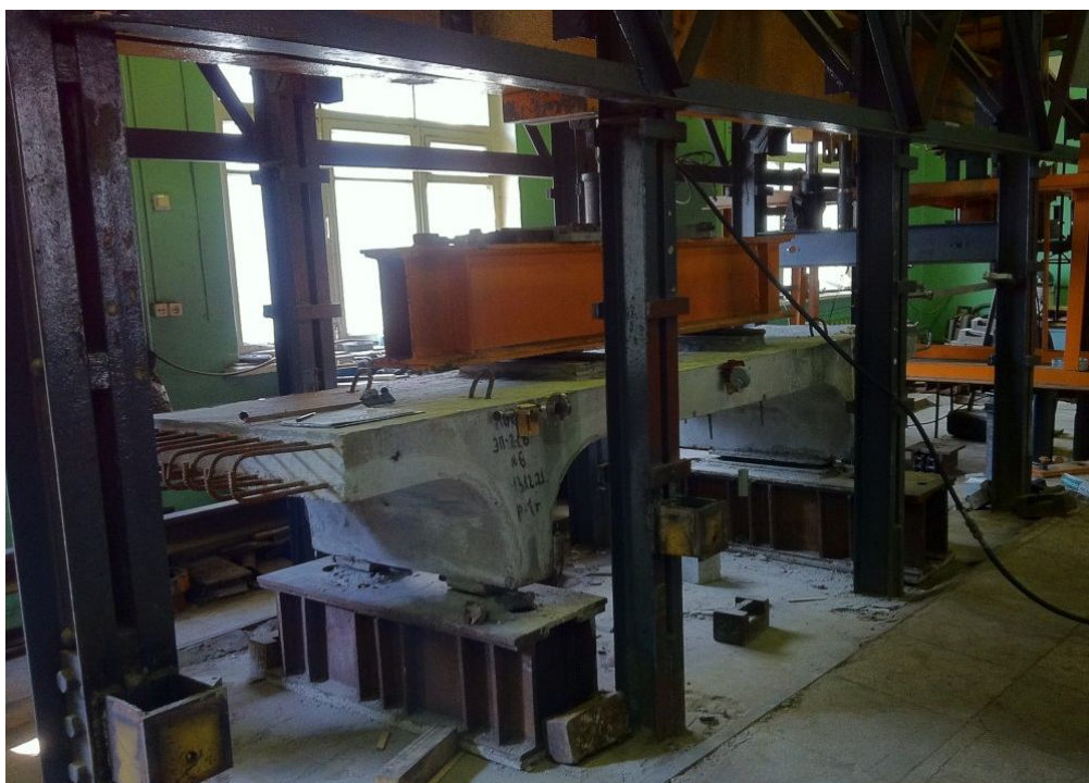
Рис. 3. Образец плиты, установленный в стенде для проведения испытаний на выносливость
