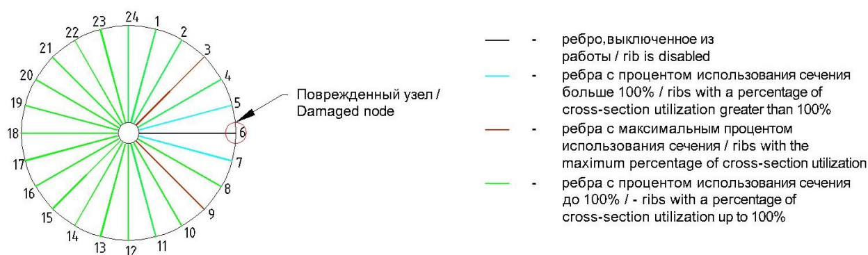
Рис. 5. Нумерация ребер купола
