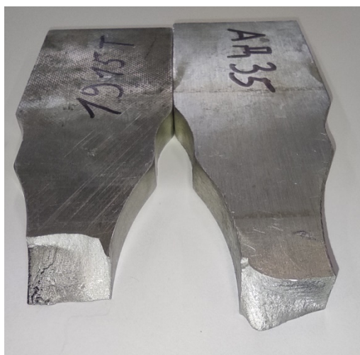
Рис. 5. Разрушенные в результате испытаний на усталость образцы Источники: выполнено О.А. Корневым.
