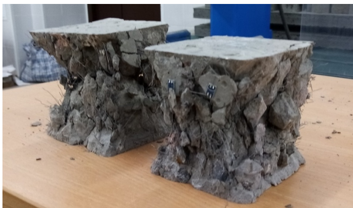
Рис. 3. Разрушенные образцы-кубы Источник: фото А.С. Марковичем, Д.А. Голишевской Figure 3. Destroyed sample cubes Source: photo by A.S. Markovich, D.A. Golishevskaja
