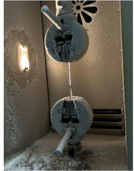
**Рис. 2.** Образец после испытания в температурной камере
