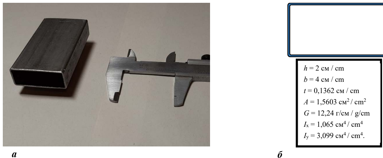
Рис. 3. Образец с коробчатым прямоугольным сечением: а — фото; б — некоторые характеристики сечения
