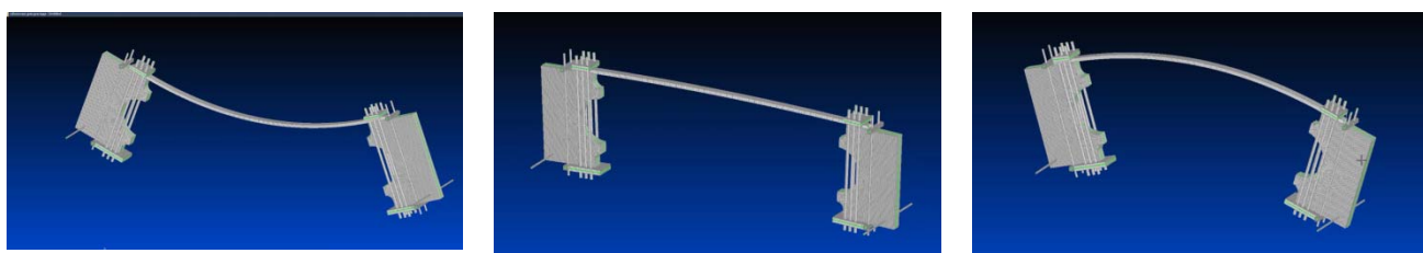
Рис. 8. Затухающие свободные колебания динамической установки, подвешенной на подшипниках качения в точках покоя Figure 8. Damped free oscillations of a dynamic installation suspended on rolling bearings at fixed points
