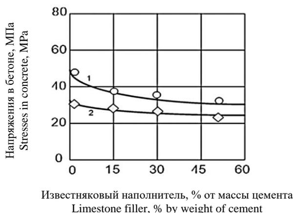
Прочность при сжатии (кривая 1) и напряжения при образовании трещин (кривая 2) в зависимости от содержания известнякового наполнителя в карбонатном мелкозернистом бетоне
