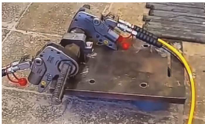
Рис. 2. Насосная станция: a – с гидравлическим ключом; б – для затяжки соединений с моментом до 5000 Нм Figure 2. Pumping station: a – with hydraulic wrench; б – for tightening connections with a torque of up to 5000 Nm
