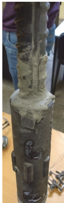
Рис. 3. Образцы винтовых муфтовых соединений арматуры: a – без контргайк; б – с затяжкой контргайк без клеевого состава; в – с клеевым составом на цементной основе Figure 3. Samples of threadbar couplings: a – without lock nuts; б – with tightening of lock nuts without adhesive composition; в – with a cement-based adhesive composition
