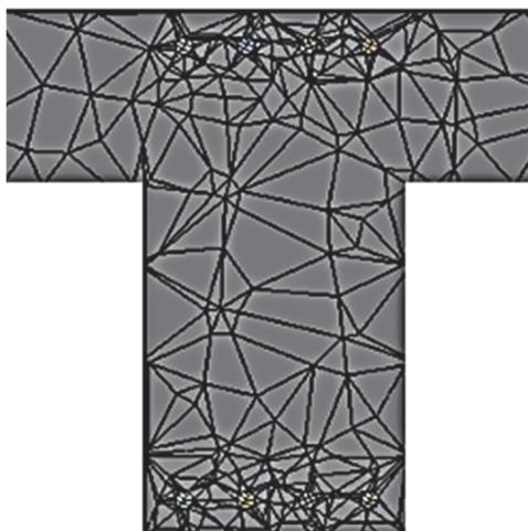
**Рис. 8.** Сетка конечных элементов в поперечном сечении армированного ребра перекрытия
