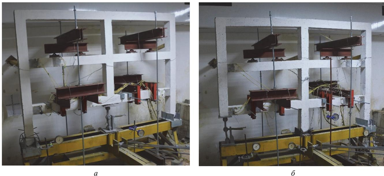
**Рис. 3.** Общий вид испытаний рам первой, РЖ-1 (а) и второй, РЖ-2 (б) серий
