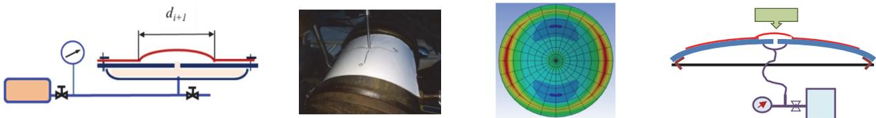
**Рис. 14.** Схемы экспериментальных установок, фото фрагмента установки, расчетное НДС
