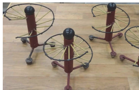
Рис. 4. Модели линейчатых винтовых поверхностей [Figure 4. Models of ruled helical surfaces]
