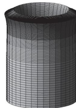
**Рис. 2.** Деформированная цилиндрическая оболочка, полученная в программе ЛИРА-САПР
