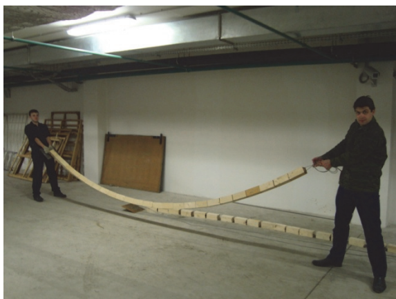
Рис. 1. Вид стержне-вантовой нити до ее трансформации в арку [Figure 1. View of the brich-cable thread before its transformation to the arch]
