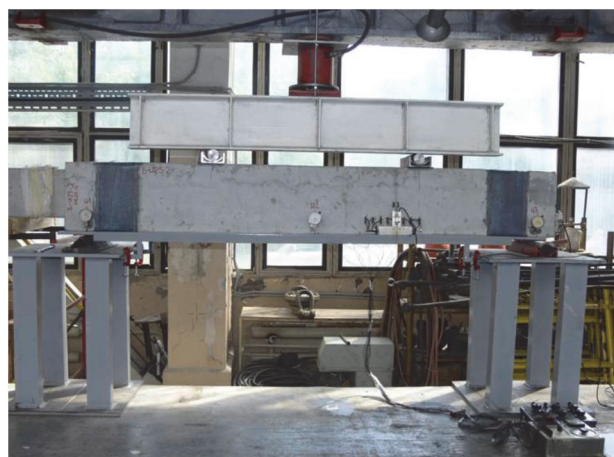
Рис. 4. Испытание железобетонных моделей [Figure 4. The reinforced concrete models testing]
