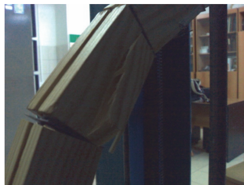
Рис. 3. Скалывание деревянных брусков при нагружении настольной модели арки [Figure 3. Splitting the timber bricks under loading the desktop model of the arch]
