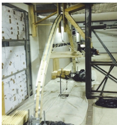
Рис. 2. Превращение нити в арку после натяжения внутренних канатов [Figure 2. Conversion thread to the arch after the internal cable tension]
