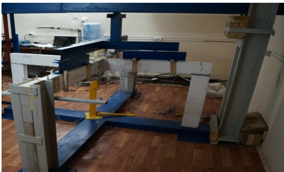
Рис. 8. Общий вид разрушения пространственной рамы после внезапного выключения центральной стойки
