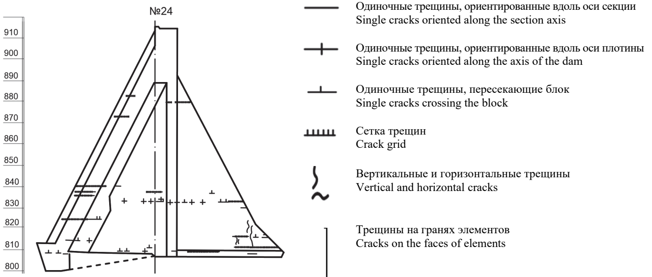
Рис. 4. Схема типичных трещин 24 секции плотины Андижанской ГЭС
