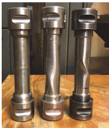
Рис. 4. Цилиндрическая оболочка из стали 45 после испытаний Figure 4. Cylindrical shell made of 45 steel after testing
