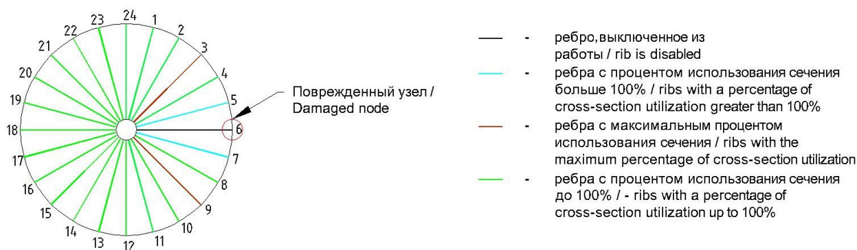
Рис. 5. Нумерация ребер купола
