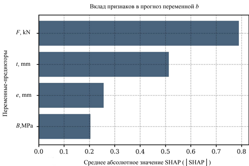
Рис. 6. Анализ важности признаков для прогнозирования ширины сечения ( b )
