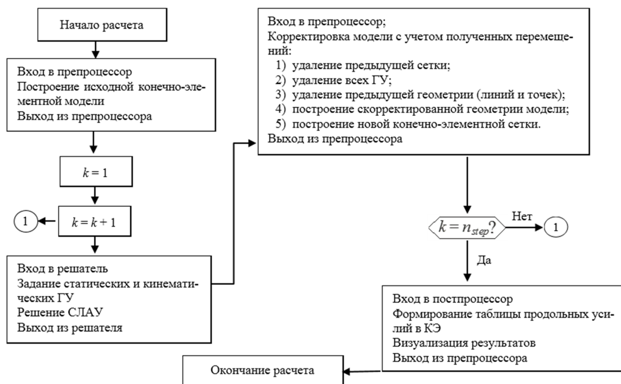
Рис. 3. Блок-схема макроса для расчета стержня с учетом корректировки геометрии: ГУ — граничные условия; СЛАУ — система линейных алгебраических уравнений
