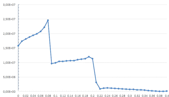
Рис. 4. Распределение эквивалентных напряжений (по Мизесу) вдоль контрольной прямой
