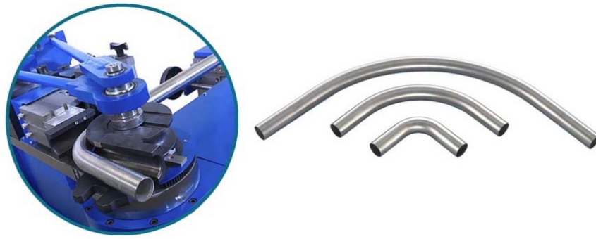
Рис. 1. Гибка труб разной кривизны Figure 1. Bending of pipes with different curvatures
