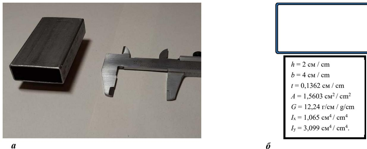
**Рис. 3.** Образец с коробчатым прямоугольным сечением:
