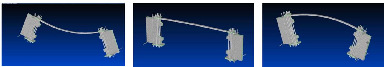
**Рис. 8.** Затухающие свободные колебания динамической установки, подвешенной на подшипниках качения в точках покоя
