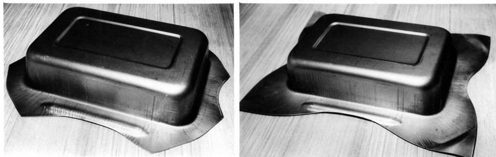
Рис. 1. Деталь «Крышка», полученная из заготовки с обрезанными (а) и необрезанными (б) углами
