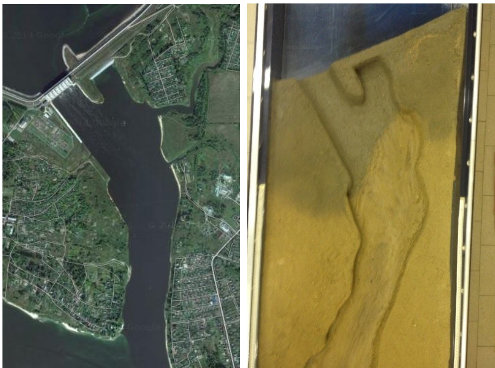
Рис. 3. Фото нижнего бьефа Рыбинского гидроузла со спутника и модель в масштабе 1:200
