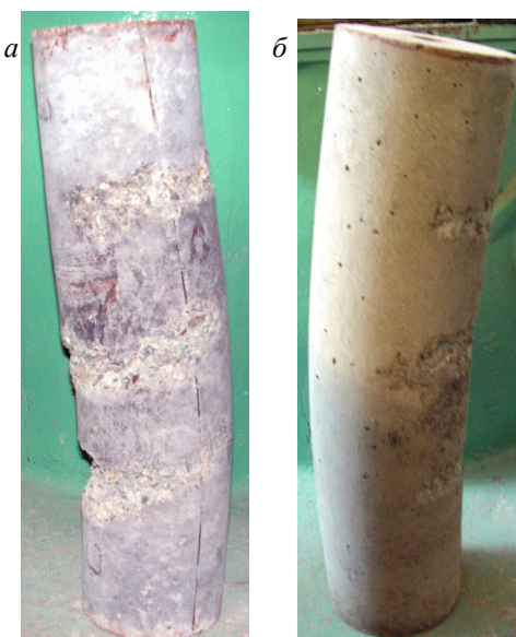
Рис. 2. Характер разрушения бетонного ядра трубобетонных элементов при осевом (а) и внецентренном (б) сжатии
