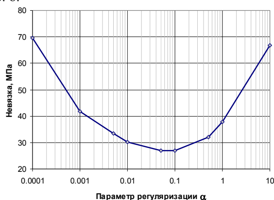
Рис. 8. Зависимость невязки решения от величины параметра регуляризации
