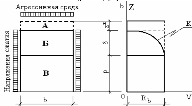
Рис. 2. Схема расположения зон различного силового сопротивления ( b – ширина сечения)
