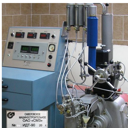
Исследовательская моторная установка для определения свойств дизельных и альтернативных топлив
