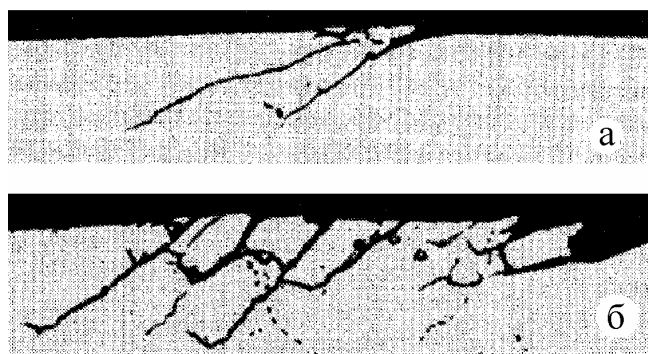
Рис.5. Последовательность выкрашивания поверхности ролика при контактном разрушении: а) — б) состояния поверхности после нарастающего числа циклов нагружения.
