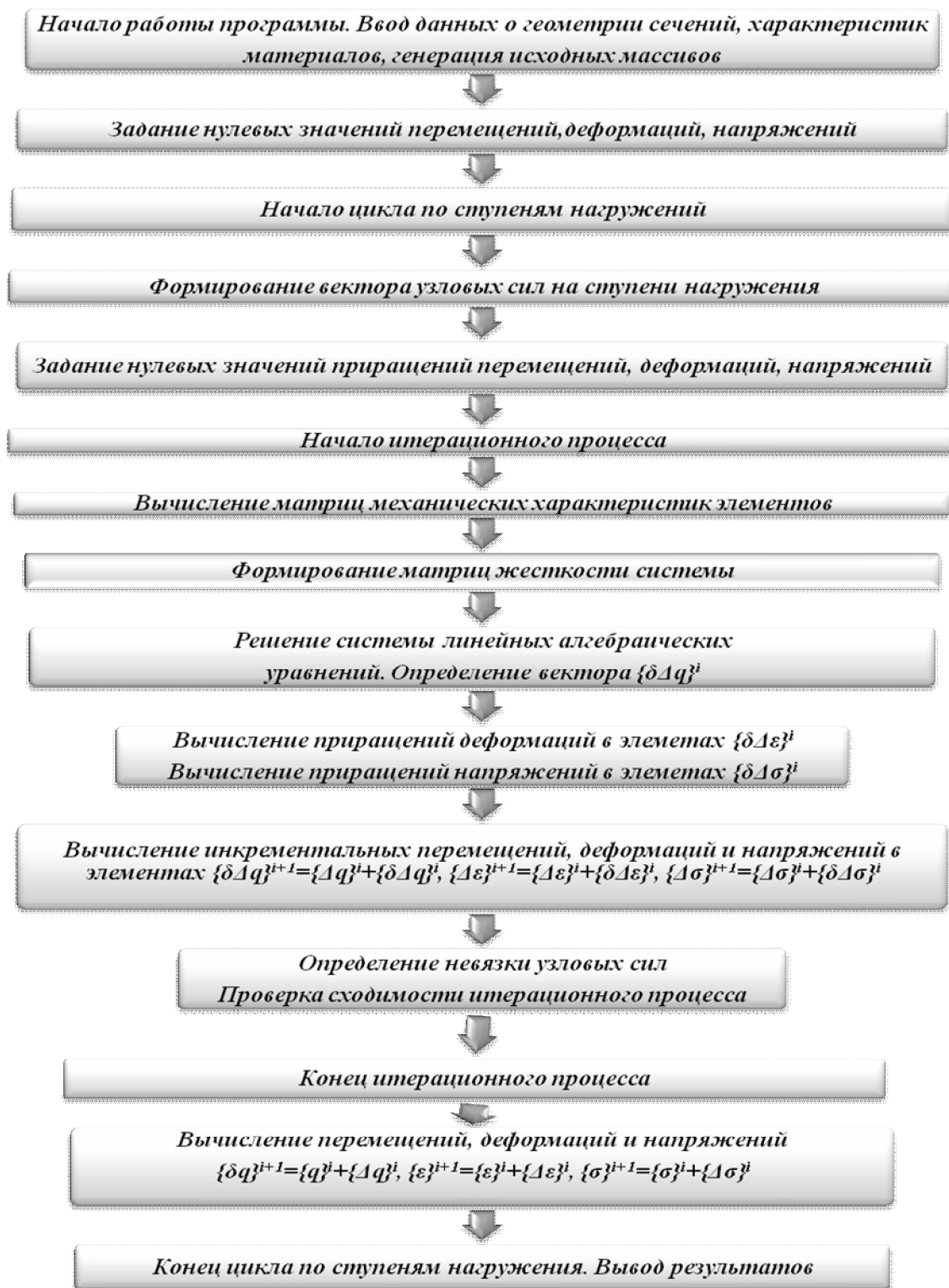
Рис. 2. Блок-схема расчета при использовании шагового метода Ньютона-Рафсона с итерационным уточнением
