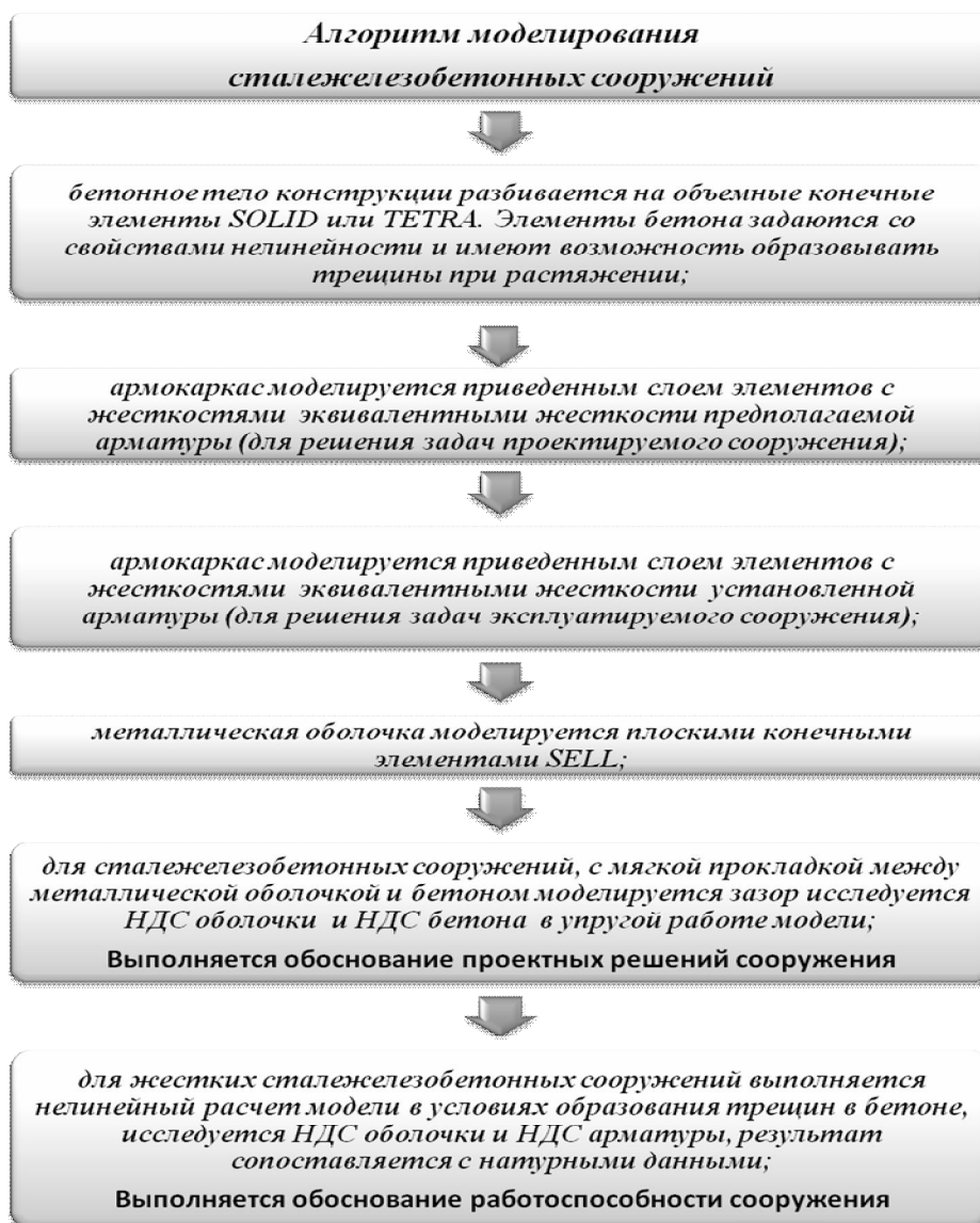
Рис.1. Алгоритм моделирования сталежелезобетонных сооружений
