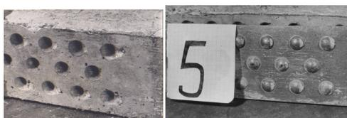
Рис. 3. «Следы» в моделях с «круглыми» выштамповками
