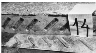
Рис. 4. «Следы» в моделях с «наклонными» выштамповками
