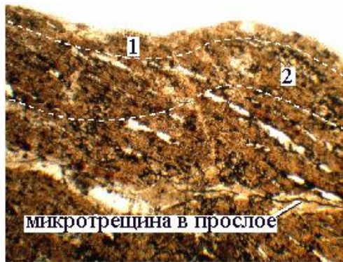
Рис. 4. Зона предразрушения в образце анизотропной породы: 1 – область разрушенной породы (до 0,12 мм); 2 – область пластических деформаций (до 0,42 мм). Увеличение в 57 раз. Микротрещина – на глубине 0,7–0,9 мм.
