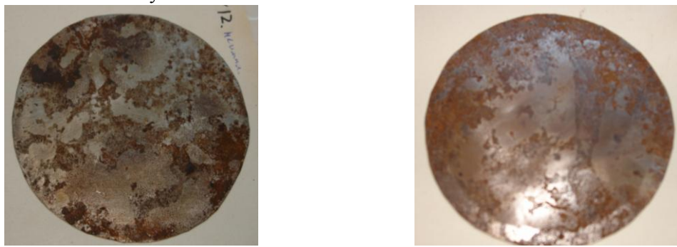
Рис. 4. Образцы из партии №12 без имплантации (слева) и с имплантацией
