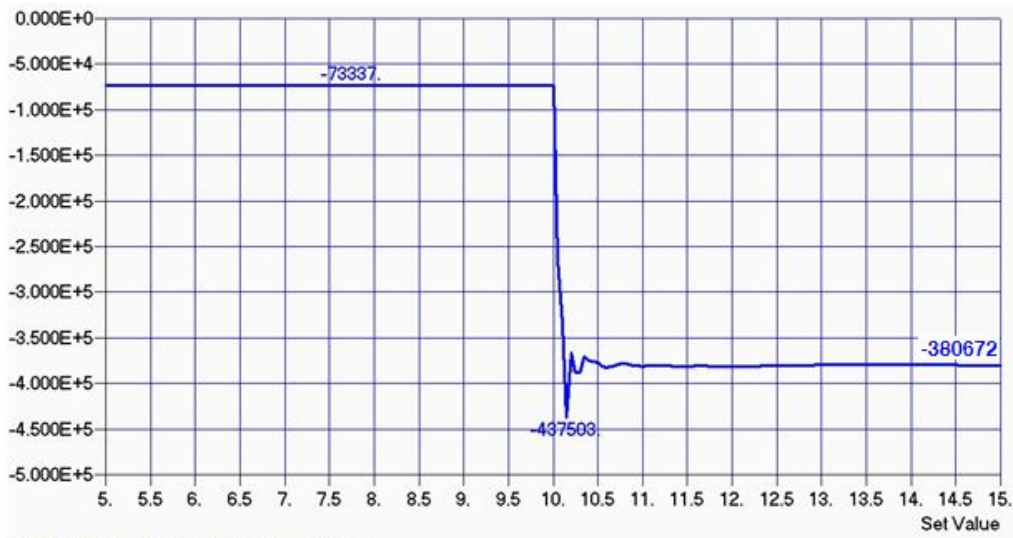
Рис. 7. График изменения изгибающего момента на опоре (Н·м) первого нижерасположенного, относительно места обрушения, ригеле во времени (с)
