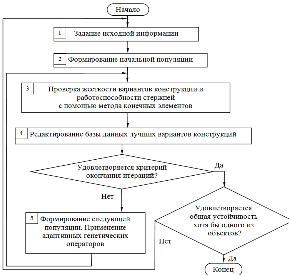
Рис. 1. Блок-схема алгоритма оптимизации
