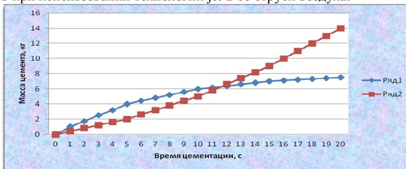
Рис. 4. Содержание цемента в теле грунтоцементной колонны в зависимости от времени цементации одного интервала: ряд 1 – Фактическое содержание цемента в теле колонны; ряд 2 – Потери цемента в виде пульпы.
