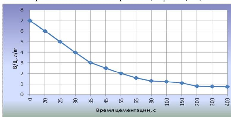
Рис. 3. Изменение водоцементного отношения в сильно обводненных грунтах в зависимости от времени цементации
