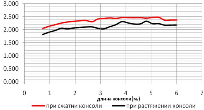
Рис. 1. Графики изменения редуцированной площади сечения расчетной схемы консоли, редуцированный момент сопротивления
