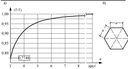
Рис. 1. Правильные n-угольники: а) график \dot{r}/\bar{r} = f(n) ; б) общий вид области
