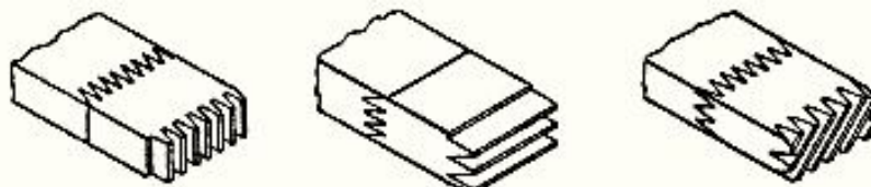
а) вертикальное б) горизонтальное в) диагональное Рис. 12. Зубчатые клеевые соединения
