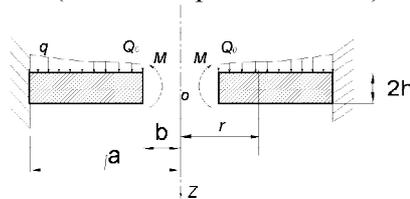
Рис. 1 Кольцевая пластинка
