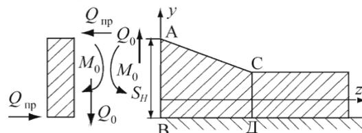
Рис. 5. Расчетная схема цельного фланцевого соединения с переходной зоной
