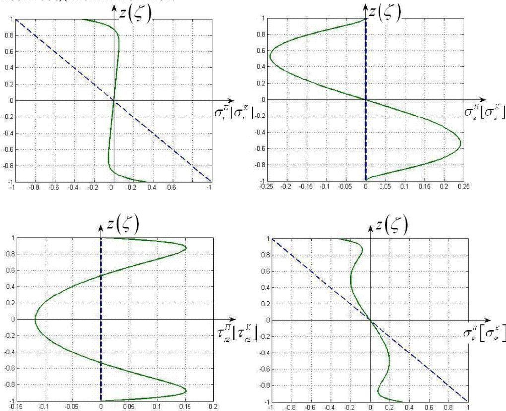
Рис. 2. Распределение напряжений плоской деформации по толщине круглой пластинки
