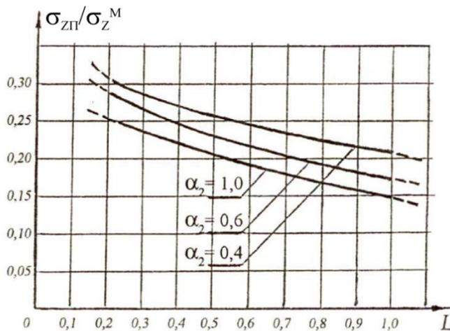
Рис. 4 Графики влияния податливости закрепленного края на нормальное напряжение
