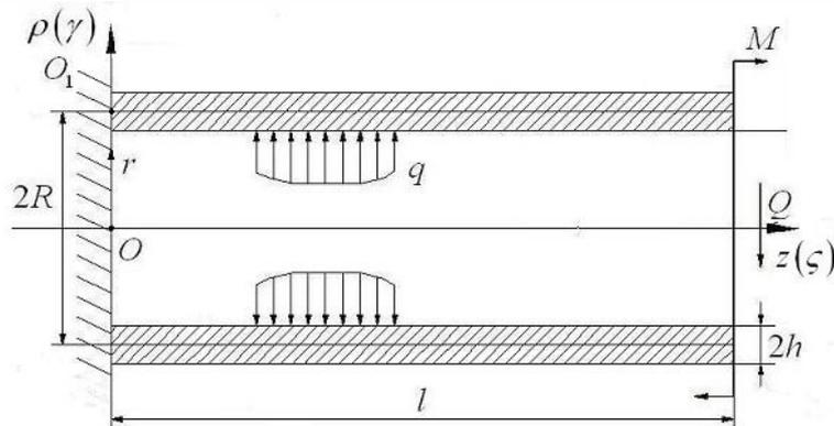
Рис. 3. Цилиндрическая оболочка
