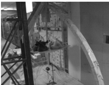
Рис. 7. Испытание арки, проклеенной эпоксидной смолой
