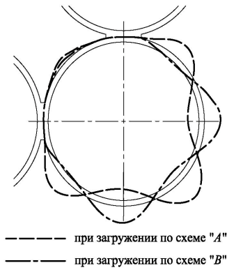
Рис. 5. Деформированные схемы плоского кольца
