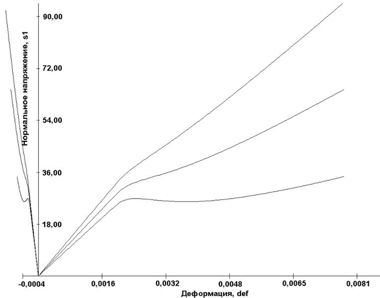
Рис. 2. Кривые нелинейного деформирования ( $\varepsilon_{11} \sim \sigma_{11}$ ,  $\varepsilon_{22} \sim \sigma_{11}$ ) композиционных материалов с хрупкой матрицей при растяжении в направлении армирования в зависимости от объемного содержания волокна  $\nu^1$ .
