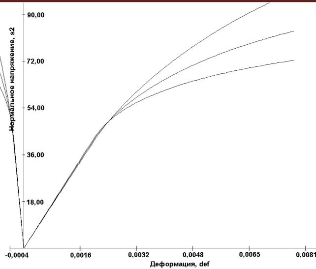
Рис. 3. Кривые нелинейного деформирования ( $\varepsilon_{22} \sim \sigma_{22}$ ,  $\varepsilon_{33} \sim \sigma_{22}$ ) композиционных материалов с хрупкой матрицей при растяжении в плоскости изотропии в зависимости от объемного содержания волокна  $v^1$ .
