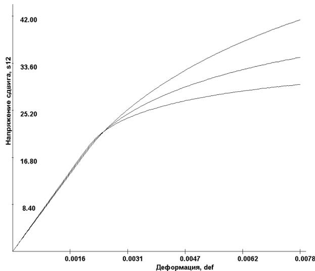
Рис. 4. Нелинейная зависимость сдвиговых напряжений  $\sigma_{12}$  от сдвиговых деформаций  $\varepsilon_{12}$  при различных значениях объемного содержания волокна  $v^1$
