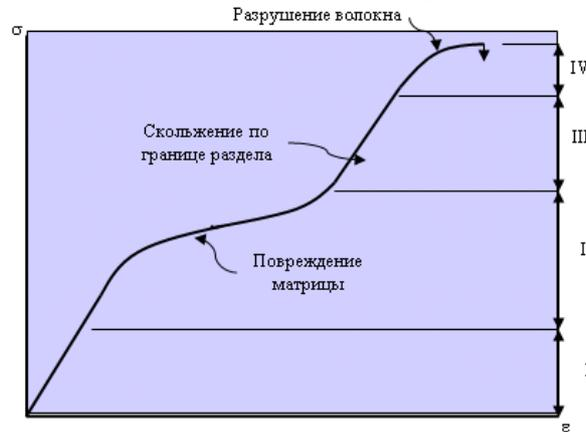
Рис. 1. Качественная картина деформирования композиционных материалов с хрупкой матрицей при монотонном нагружении
