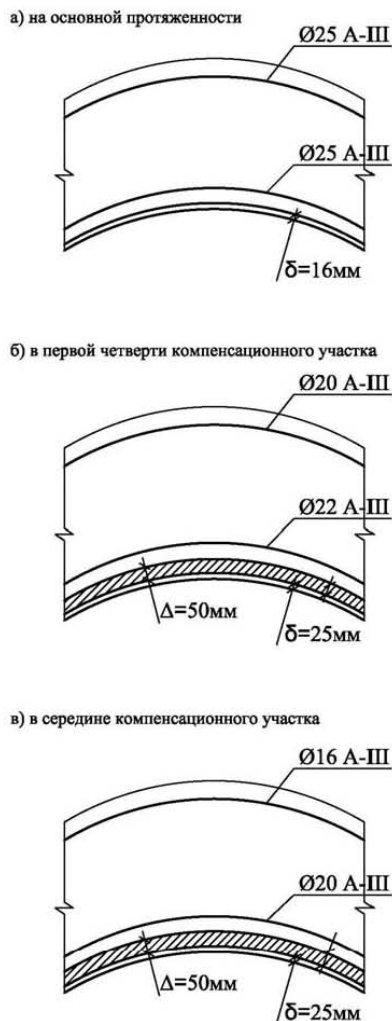
Рис. 3. Разработанная схема сталежелезобетонного напорного водовода
