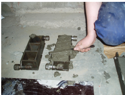
Рис. 4. Изготовление контрольных кубиков для испытаний
