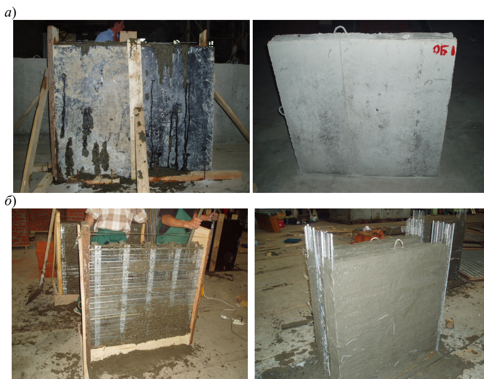
Рис. 2. Опытные образцы: а – изготовленные в традиционной опалубке, б – изготовленные с применением СНО
