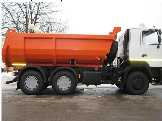
Рис. 2. Расчётное транспортное средство МАЗ-6501 (грузоподъёмность порядка 20 тонн, полная масса 33,5 тонны).
