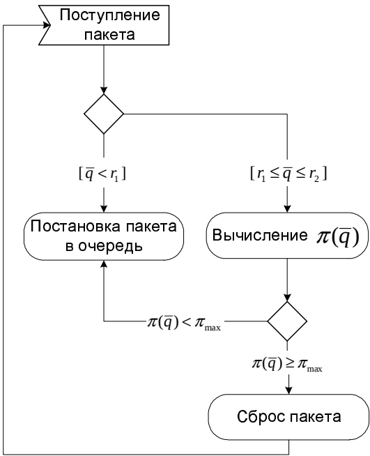
Рис. 1. Диаграмма функционирования RED.
