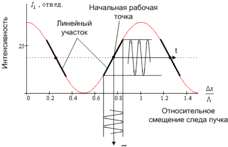
Рис. 4. Зависимость интенсивности первого дифракционного порядка от относительного смещения решеток. Рабочая точка находится на середине линейного участка.
