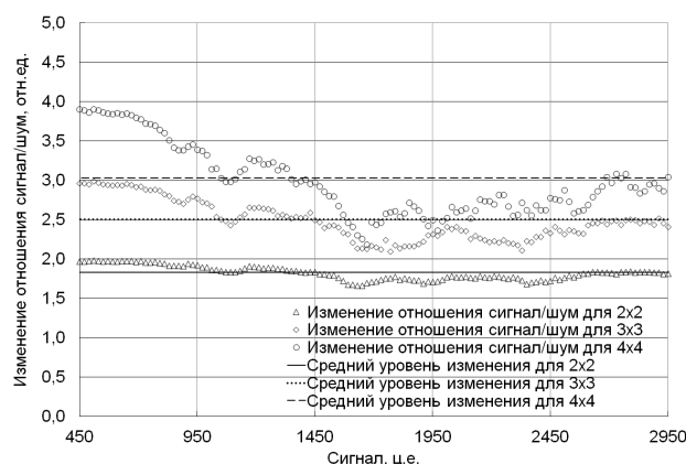
Рис. 10. Относительное изменение отношения сигнал/(временной шум), за счёт применения пространственным усреднением при M = 4 («2 × 2»), M = 9 («3 × 3») и M = 16 («4 × 4»). Получено для изображения тестового объекта (см. рис. 7)
