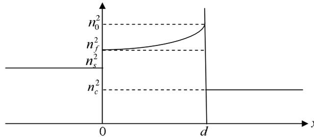
Рис. 1. Асимметричный экспоненциальный профиль показателя преломления,  $d$  — высота имплантированного слоя
