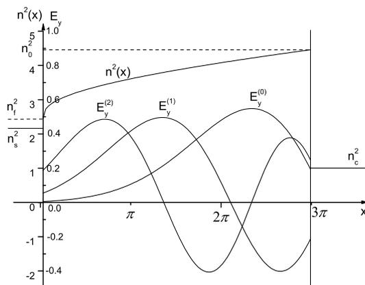
Рис. 4. Профиль показателя преломления с модификацией (12) ( $\alpha = 1/3$ ) и собственные функции  $E_y^{(j)}$  задачи (1), (12), (3), (4),  $d = 3\pi$ ,  $\Delta = 0.4773$
